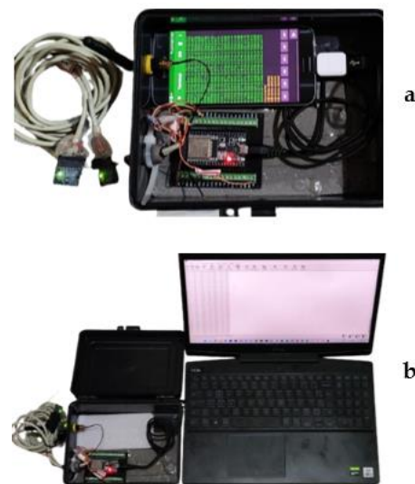
Figura 5. Imagem real do sistema de aquisição e disposição dos componentes utilizando smartphone (a); laptop (b). Fonte: AUTOR.
